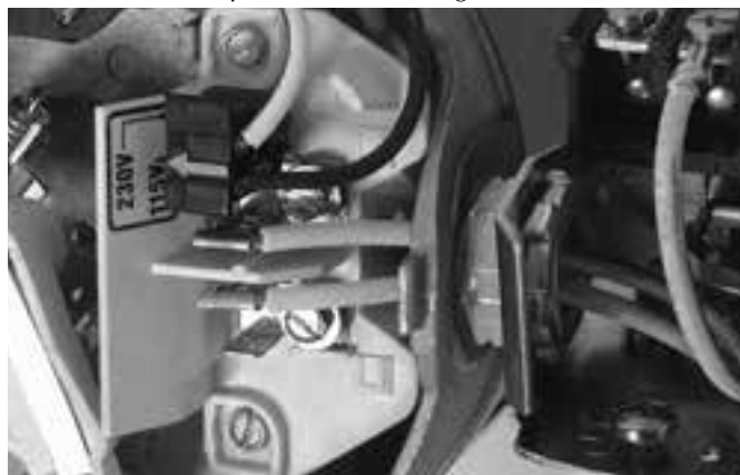
Figura 7: Tensión configurada para 115 voltios, tipo ficha
